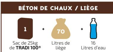
Dans la bétonnière, introduire le liège et 14 litres d'eau, Malaxer environ 3 minutes pour humidifier le liège puis ajouter un sac de chaux Pure Tradi 100® NHL 5 ; Ajuster si nécessaire le dosage en eau afin d'obtenir un mélange homogène.
