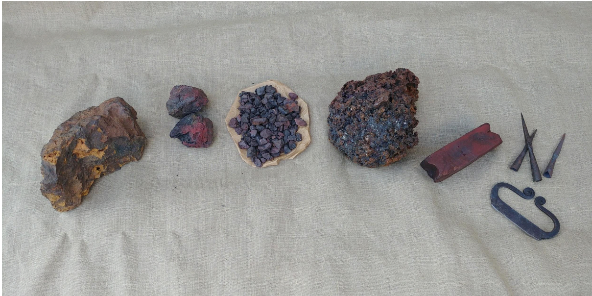
De gauche à droite : minerai de fer, minerai grillé, loupe, barreau de fer, objets Forgés
